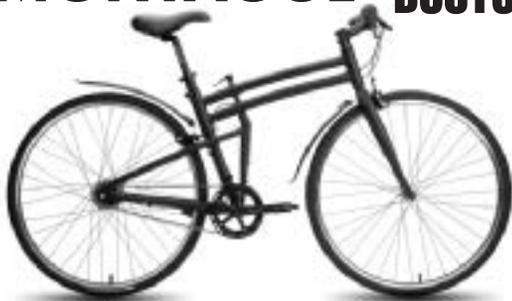
Die Ingenieure von MONTAGUE haben das patentierte FIT™-Faltsystem entwickelt. Es garantiert eine sehr verwindungssteife Rahmenkonstruktion und einfachste Bedienung. Durch das Concentrus™-System (Rohr-in-Rohr-Design) integriert sich der Faltmechanismus harmonisch in das Rahmen-Design und verleiht dem MONTAGUE-Faltrahm die Optik eines sportlichen Rades.
